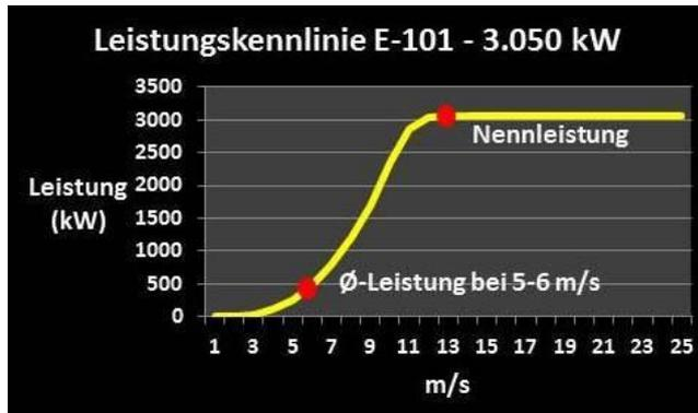
die Windgeschwindigkeit auf 6 m/s bzw. 4 Bft, dann erhöht sich die Erzeugungsleistung auf rund 480 kW; das sind knapp 16 Prozent der Nennleistung dieses Typs.
